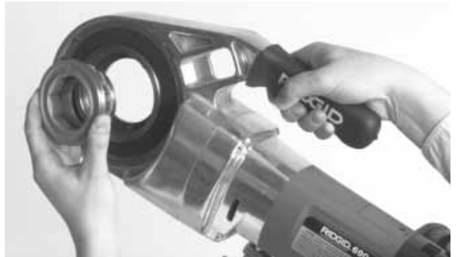
Figura 2 – Instalación del adaptador para el cabezal de terrajas No. 11-R
