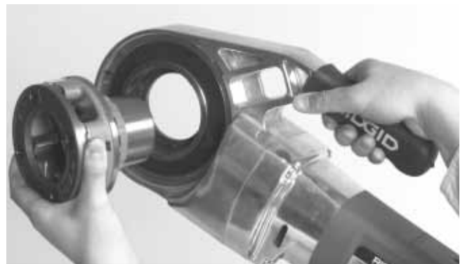
Figure 3 – Instalación de un cabezal de terrajas No. 11-R
