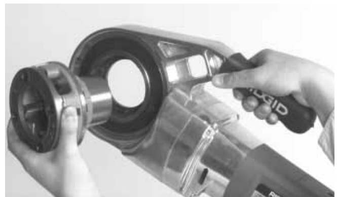
Figure 3 – Installation des têtes de filière type 11-R
