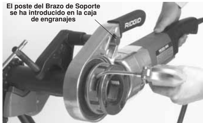
Figura 7 – Aplicación de aceite mientras se rosca
