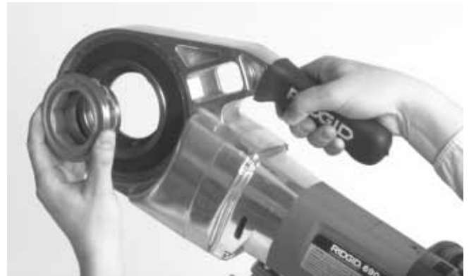
Figure 2 – Installation de l'adaptateur de têtes de filière type 11-R
