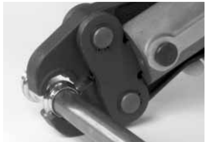
Figura 5 – Montaje de las mordazas alrededor del acoplamiento
