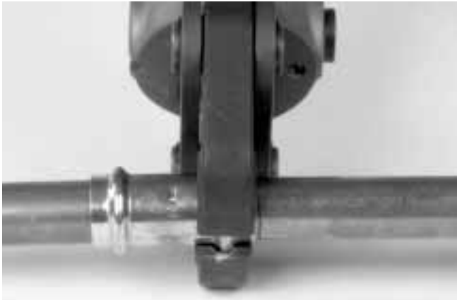
Figure 6 – Sertisseuse CT400 à l'équerre du tube
