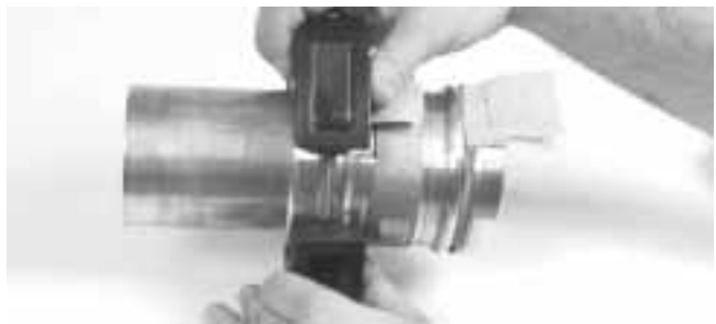
Figura 8 – Instalación del aro sobre el acoplamiento
