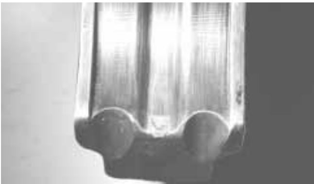
Figura 10 – La acumulación de residuos en las mordazas requiere limpieza
