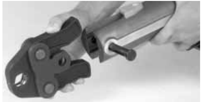
Figura 3 – Montaje del juego de mordazas en la CT400
