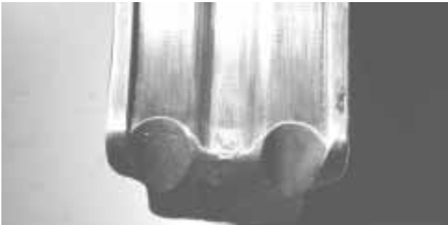
Figure 10 – Accumulation de résidus de sertissage nécessitant le nettoyage des mâchoires
