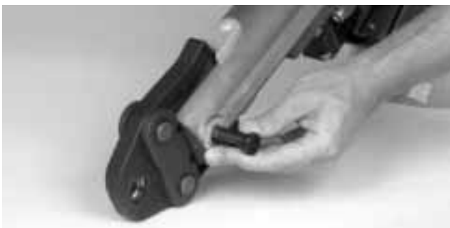
Figura 2 – Para montar las mordazas, jale el pasador
