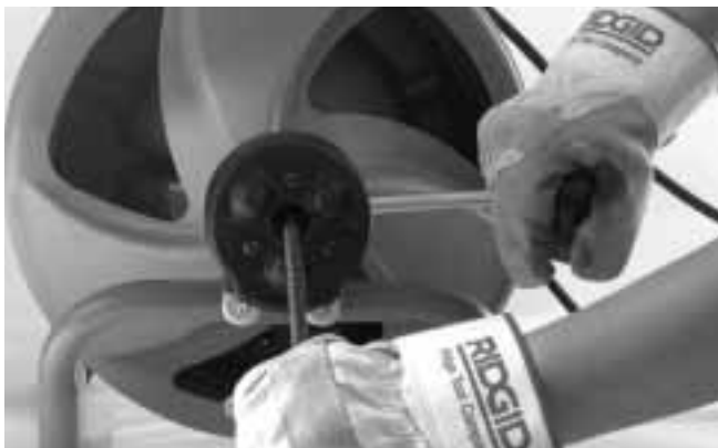
Figura 8 – Auto-alimentador en posición de reversa
