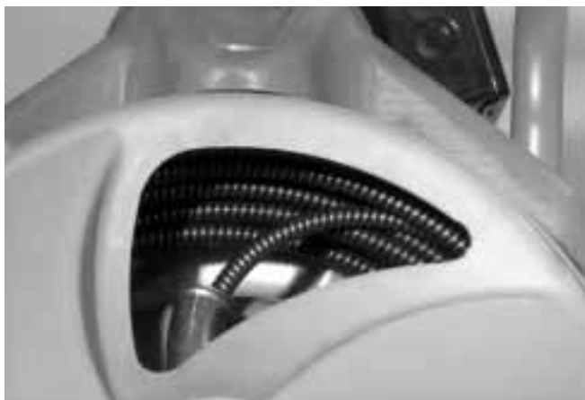
Figure 9 – Embobinez le câble dans le tambour comme indiqué
