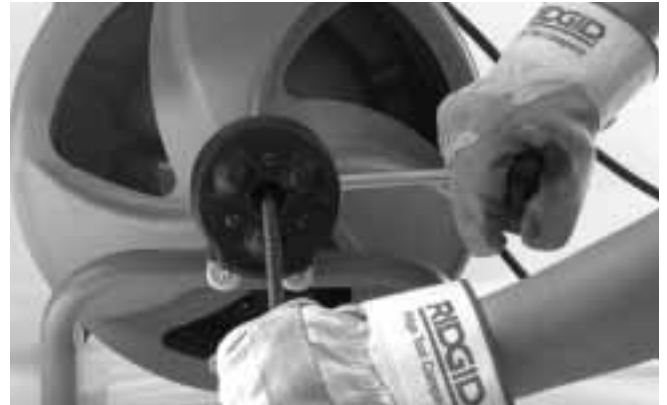
Figure 8 – Système d'avancement automatique en position marche arrière
