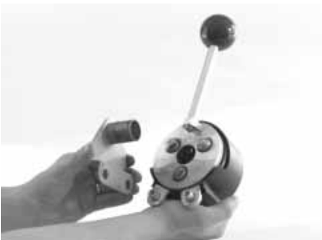
Figura 2 – Colocación del soporte de montaje en el auto-alimentador
