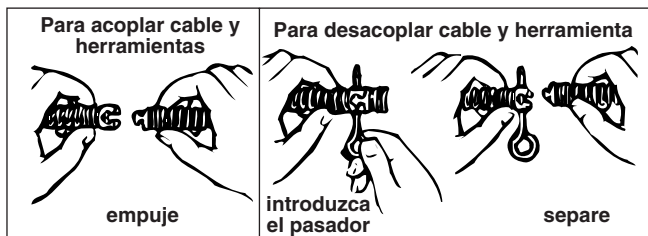
Figura 5 – Acoplamiento y desacoplamiento de las herramientas
