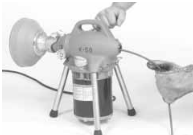
Figure 5 – Montage de l'adaptateur de câble
