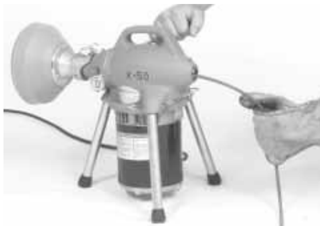
Figura 5 – Acoplamiento del adaptador para el cable
