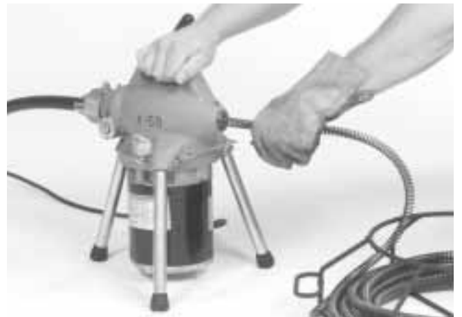
Figure 3 – Introduction du câble par l'avant de la machine
