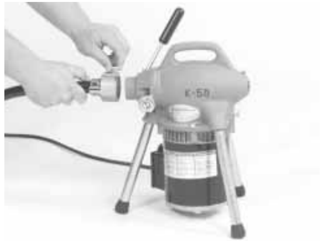
Figure 2 – Montage du guide-câble arrière
