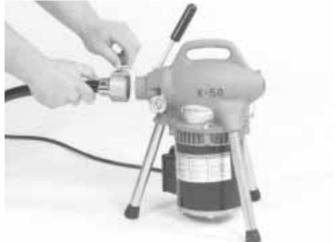
Figura 2 – Acoplamiento de la manguera guía trasera
